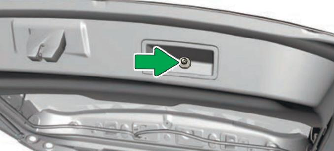
3 Освободите **клипсы** и снимите нижнюю облицовку крышки багажника, снимите разъем кнопки закрывания багажника.
