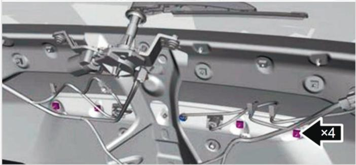
6 Сожмите **4 фиксатора** и снимите камеру заднего вида.
